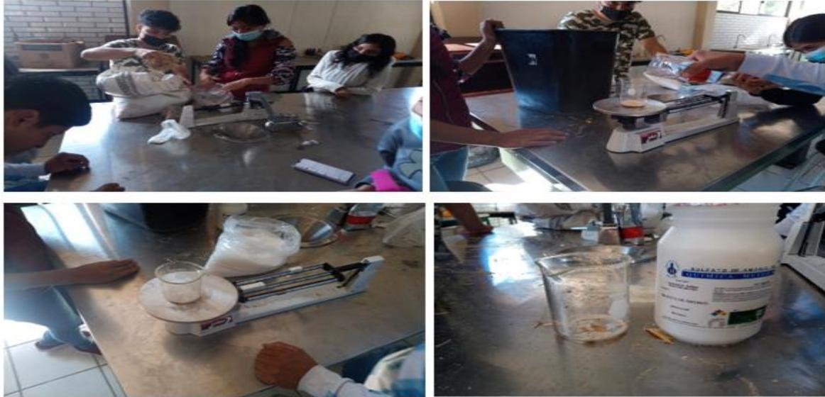
Una vez que los ingredientes fueron pesados en las proporciones correctas se procedió a mezclar de forma manual, para que el hongo de la levadura realice su trabajo se agregó agua con ayuda de una probeta, se fueron agregando 200 ml. A la vez hasta notar que la toda la mezcla esté húmeda, por lo que al final la cantidad de agua que se agregó fueron 1.2 litros.
